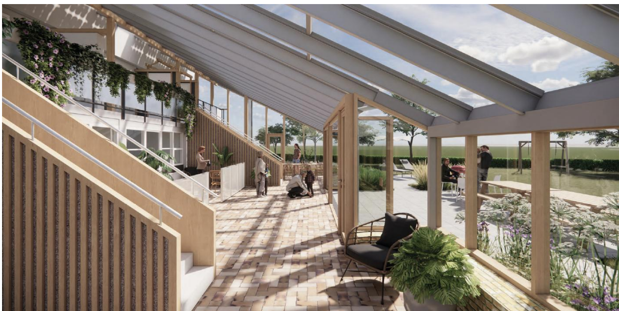
Illustration af forslaget. Bemærk at illustrationen mangler forventet forstærkning af taget i form af træsøjler.
